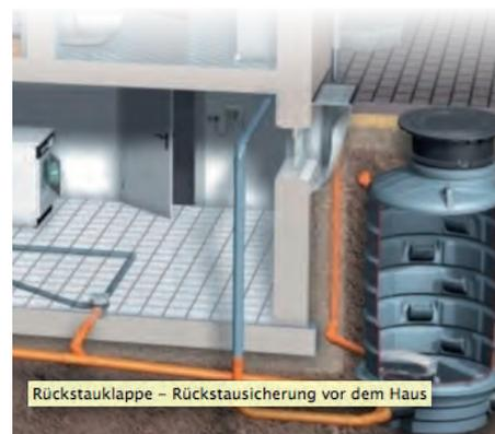
**Rückstausicherung vor dem Haus:** Der Rückstauverschluss kann auch in einem Hausanschlussschacht vor dem Gebäude installiert werden. Dieses System (z.B. von der Firma Kessel) ist wartungsfreundlich und geräuscharm. Zusätzlich können im Schacht Pumpen und Fäkalienhebeanlagen installiert werden, die im Keller viel Platz beanspruchen würden.
