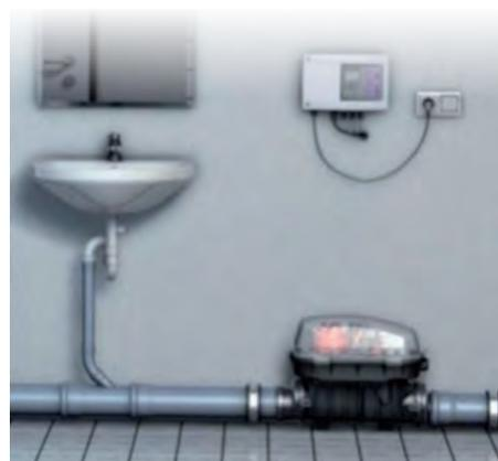
**Fliegender Einbau:** Bei rückstaugefährdeten Altbauten empfiehlt es sich, eine zentrale Rückstausicherung in eine bereits vorhandene freiliegende Abwasserleitung einzubauen. Der Arbeitsaufwand ist gering und die Wartung des Rückstauaggregats einfach.
