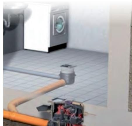
**Einbau in den Boden:** Das Rückstauaggregat lässt sich auch versteckt in den Boden einbauen. Gerade bei Neubauten schafft diese Variante zusätzlichen Wohnraum im Keller. Weitere Sicherheit bieten Abdeckungen mit Ablauffunktion für zusätzliche Oberflächenentwässerung (z.B. bei Kellerüberflutungen). Dichtungen schützen von unten vor drückendem Wasser.
